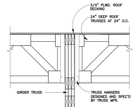
**8. ROOF BEAM TO JOIST GIRDER CONN.**
